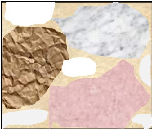
Ungesättigte Mischung ist eine sicher berührende Körnung mit bindigen Anteilen (Ton), die nicht die Hohlräume füllen können - ist erdfeucht aufgebracht und verdichtet, hoch Druck-belastbar und besitzt Diffusion-hemmende Merkmale. (Optimierung der Mengenverhältnisse für den speziellen Fall – inkompressibler Verschluss von aufgefahrenen Lagerschächten auf der Sohle der Kammern mit kleinen Schachtscheiben)
